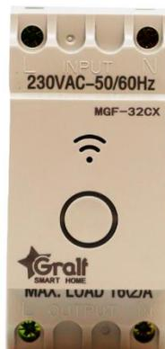
Este dispositivo actúa en forma de ON/OFF y puede ser conectado a la red eléctrica con una tensión de 220V. Es manejado a través de una aplicación mediante su dispositivo inteligente, con lo cual puede controlar televisores, ventiladores, aires acondicionados, y todo aquel dispositivo que tenga un consumo menor a 20A. Ideal para montar sobre un tablero con rieles din. También cuenta con un pulsador de ON/OFF para la activación manual, en caso de quedar sin red WiFi.
